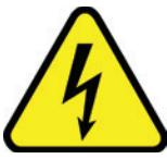
**RIESGO ELÉCTRICO** En la que puede sufrir descargas eléctricas, si no se cumplen las disposiciones de seguridad eléctrica.
